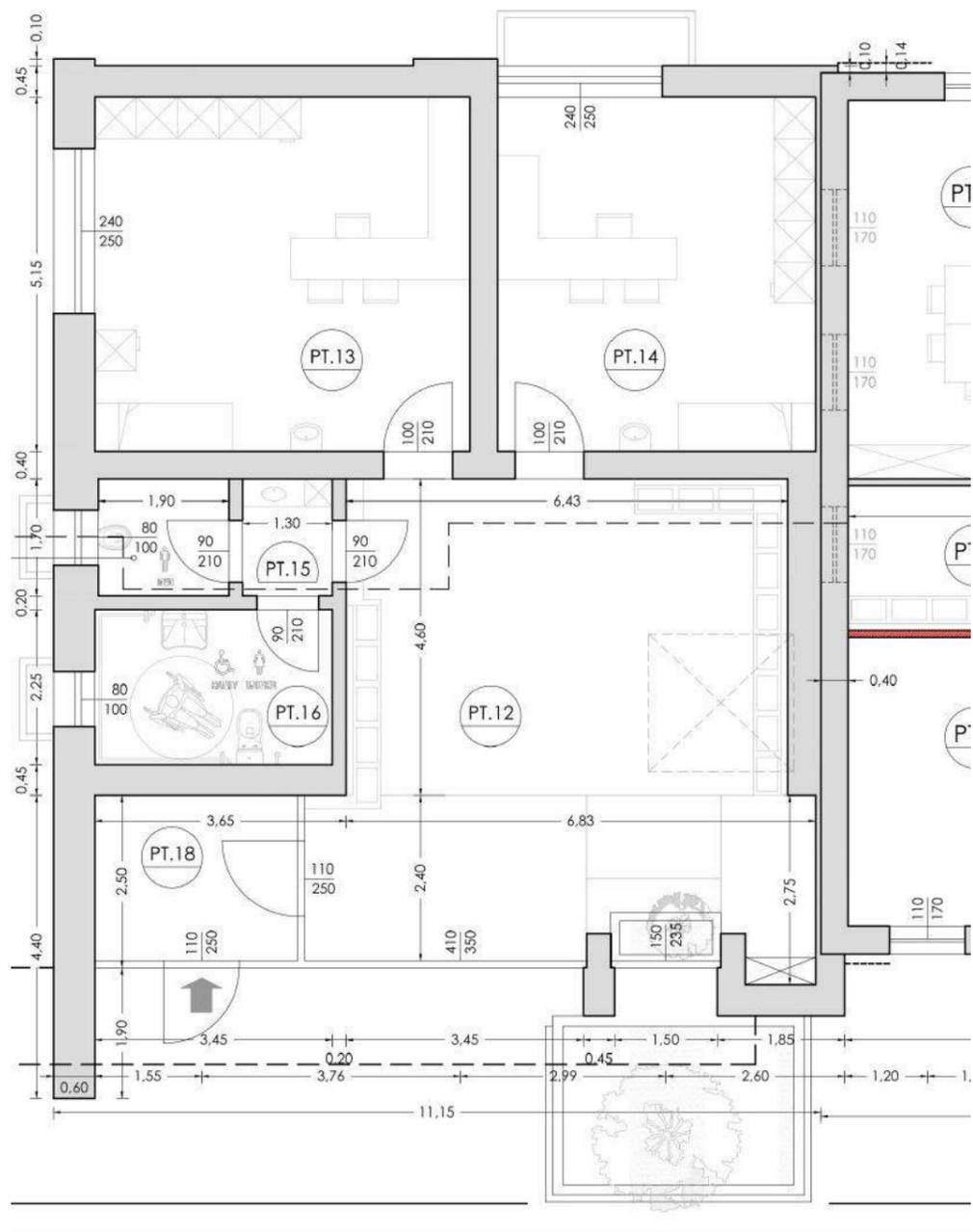
Il nuovo ambulatorio risulta accessibile e dotato dei servizi necessari, si propone la realizzazione di smussi di raccordo metallici per risolvere l'unico problema dato dalle soglie di ingresso delle due porte che presentano un traverso di protezione dall'acqua.
